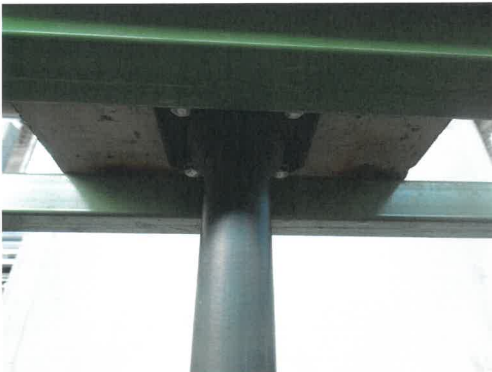
Bild 6 Versuchsaufbau Wasserdichtheit, Sparten-Hauseinführung S-HEF ohne Wasseraustritt
