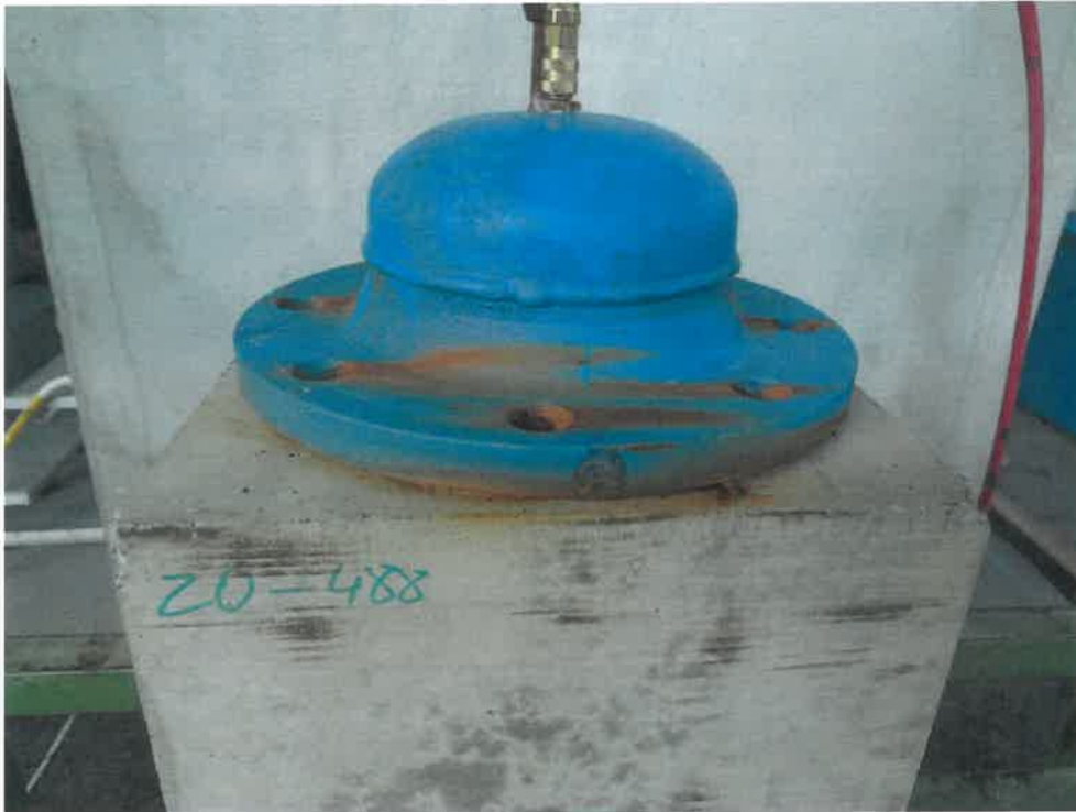
Bild 5 Versuchsaufbau Wasserdichtheit mit aufgeklebter Druckglocke
