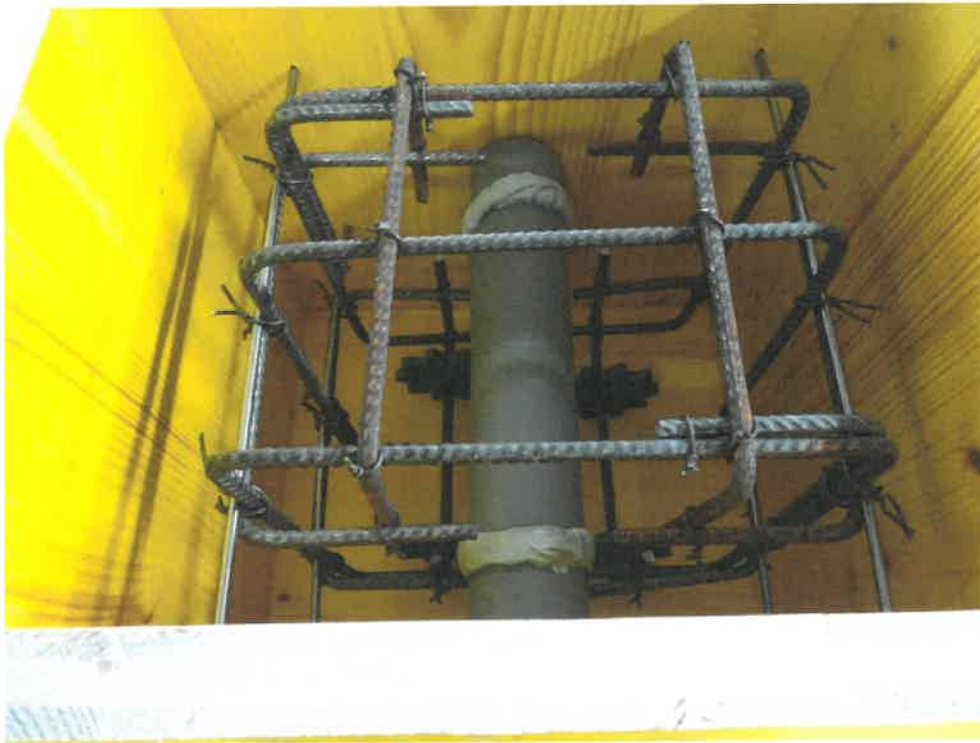
Bild 1 Herstellung des Prüfkörpers und Einbau des Kunststoffrohres
