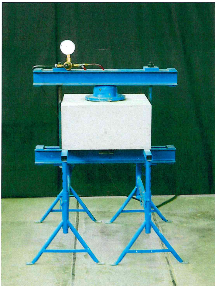
Bild 4: Prüfkörper während der Dichtigkeits- prüfung mit 10 bar Wasserdruck
