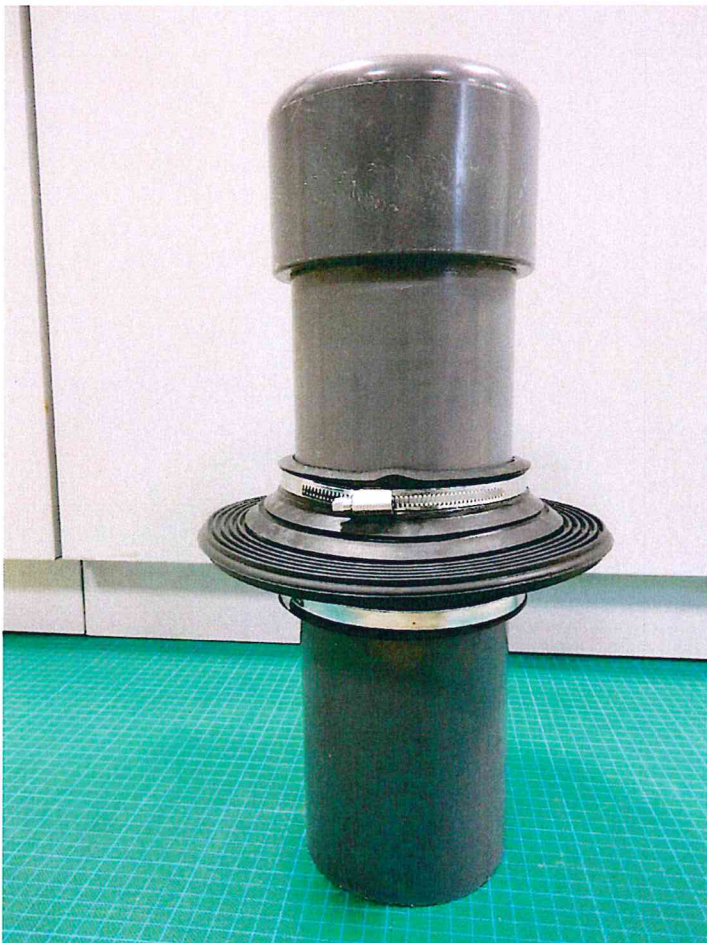
Bild 2: druckwasserdicht verklebtes PVC-U- Rohr PN16 mit Endkappe
