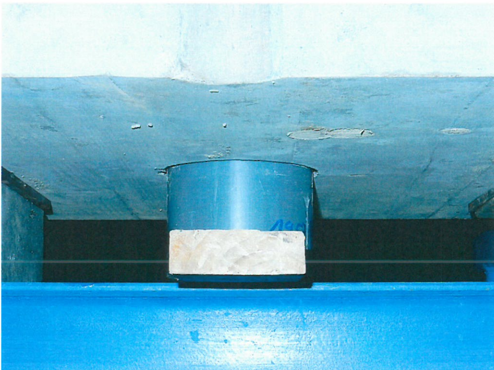
Bild 4 Kontrollmöglichkeit an der Unterseite des Prüfkörpers während der Dichtigkeitsprüfung
