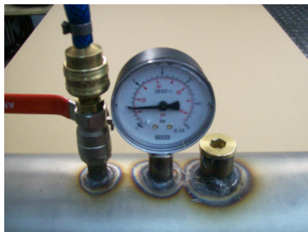
2. Prüfstufe 1,0 bar / 24 Std.
