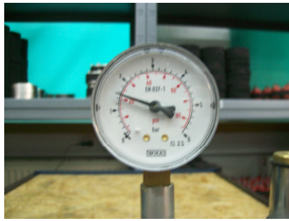
3. Prüfstufe 1,5 bar / 24 Std.
