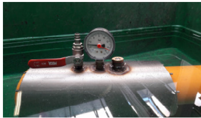
5. Prüfstufe 3,0 bar / 24 Std.
