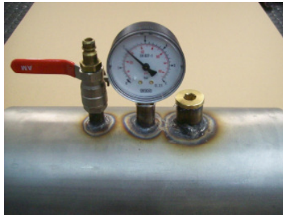
4. Prüfstufe 2,0 bar / 24 Std.
