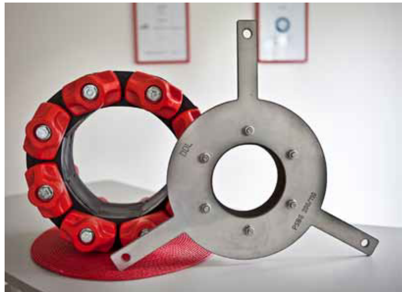
Bei den Ringraumdichtungen wird meist die Gliederketten-Variante (links) und seltener die Pressring-Dichtung (rechts) verwendet. Durch die Laschen kann die Pressringdichtung an die Behälterwand gedübelt werden und ist dadurch gegen Austrieb gesichert.
