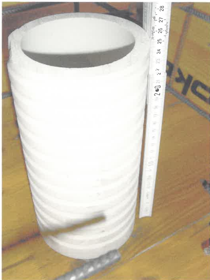
Bild 1: DDL PQZ Futterrohr DN 100 vor dem Betonieren des Prüfkörpers
