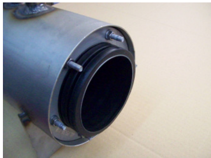
Medienrohr Kabuflex DN 100 in Prüfvorrichtung ID 150 mm
