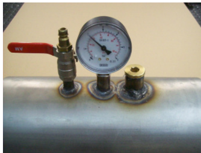
4. Prüfstufe 2,0 bar / 30 Min.
